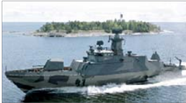
Finlands modernaste robotbåt av Haminaklass. Fartygen är 51 meter långa med displacement på 250 ton.
